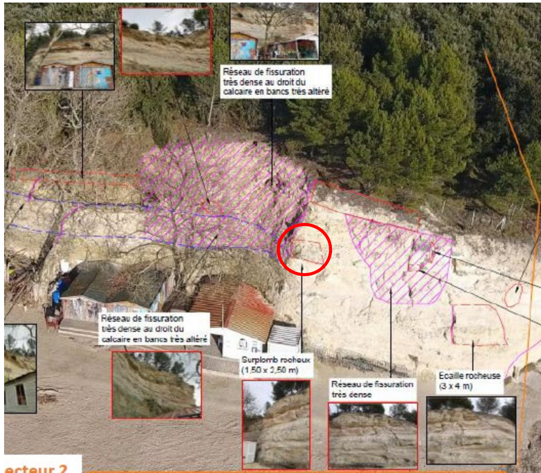
Illustration 16 - Planche photographique établie par Anteagroup identifiant (cercle rouge) le compartiment rocheux menaçant, en surplomb, en périphérie de la cicatrice d'arrachement du 26 septembre 2024
