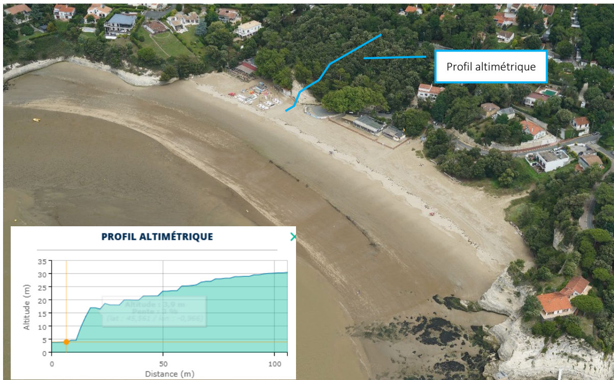
Illustration 6 - Vue aérienne oblique de la conche des Nonnes (©Observatoire de la côte de Nouvelle-Aquitaine, TechniVue, 2023) et profil altimétrique au droit de la zone touchée par l'instabilité de terrain (données topographiques https://www.geoportail.gouv.fr/carte )
