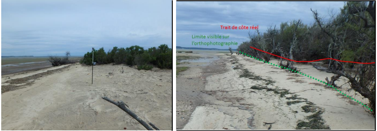
Figure 4 : Localisation de la position du trait de côte : à gauche, rupture de pente indiquée par la perche du DGPS au nord-ouest de l'île (entre les profils 7 et 8) ; limites de végétation à droite, à proximité du profil 7 sur la façade ouest de l'île (interprétations possibles en fonction de l'état des tamaris)
