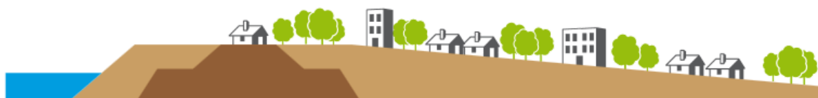
Figure 9 : Schéma de principe d'une super-digue. Source CEPRI (2015).
