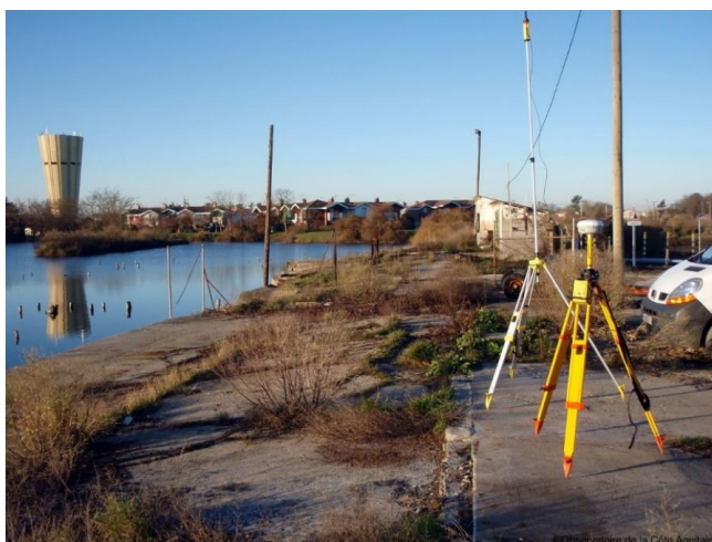
Figure 2 : Levé topographique à Gujan-Mestras (Bassin d'Arcachon) ©Observatoire de la Côte Aquitaine
