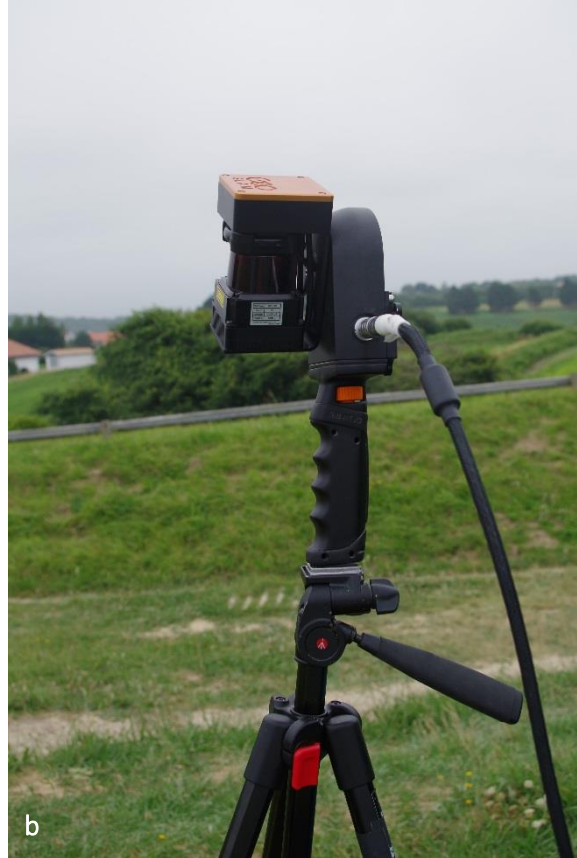
Illustration 6 : Initialisation du scanner sur trépied. a) Vue générale. b) Détail de la tête du scanner.
