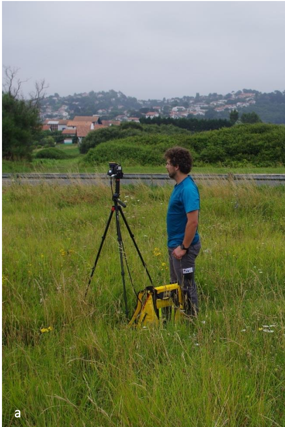
Illustration 6 : Initialisation du scanner sur trépied. a) Vue générale. b) Détail de la tête du scanner.
