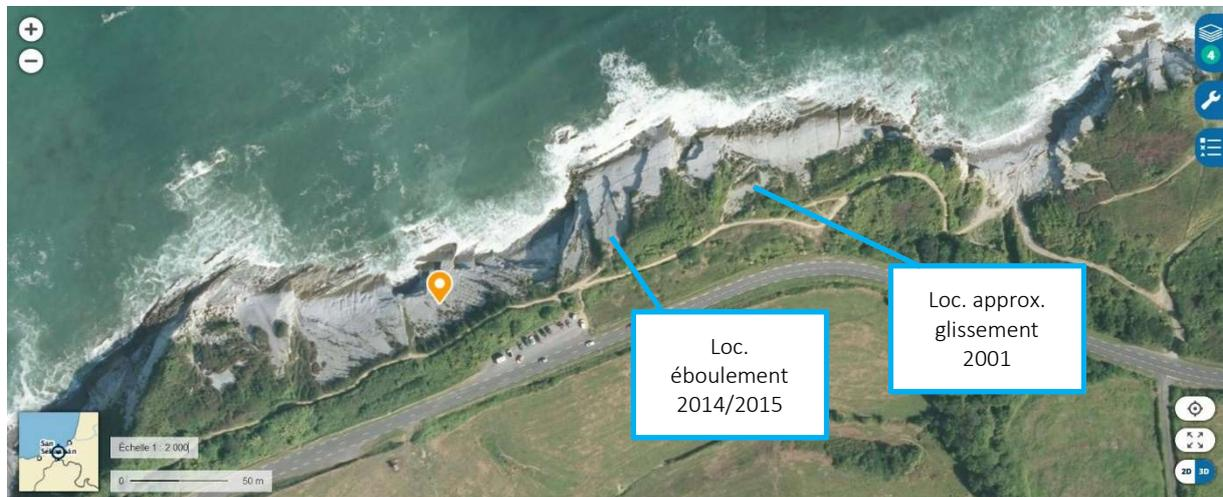
Figure 2 : Position de l'éboulement au nord-ouest du parking de la crique des Viviers basques (fond orthophoto IGN ; <https://www.geoportail.gouv.fr/>).
