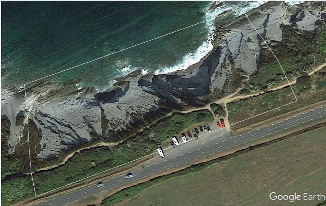
Figure 18 : Proposition de périmètre de suivi pour un levé photogrammétrique par drone. Le secteur représenté a une emprise de 200 x 80 m (fond GoogleEarth).
