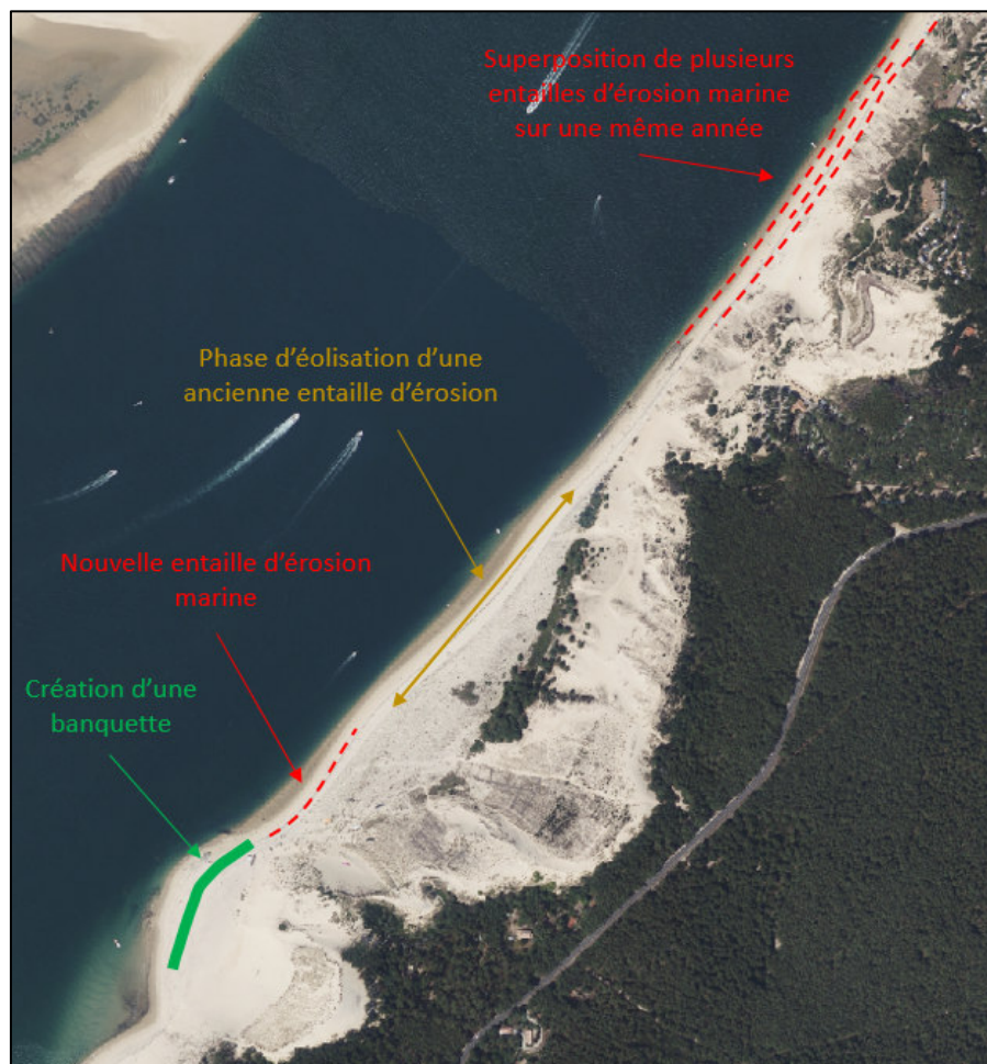
Figure 3 - Exemple d'entailles d'érosion marine (Source ONF 2024)
