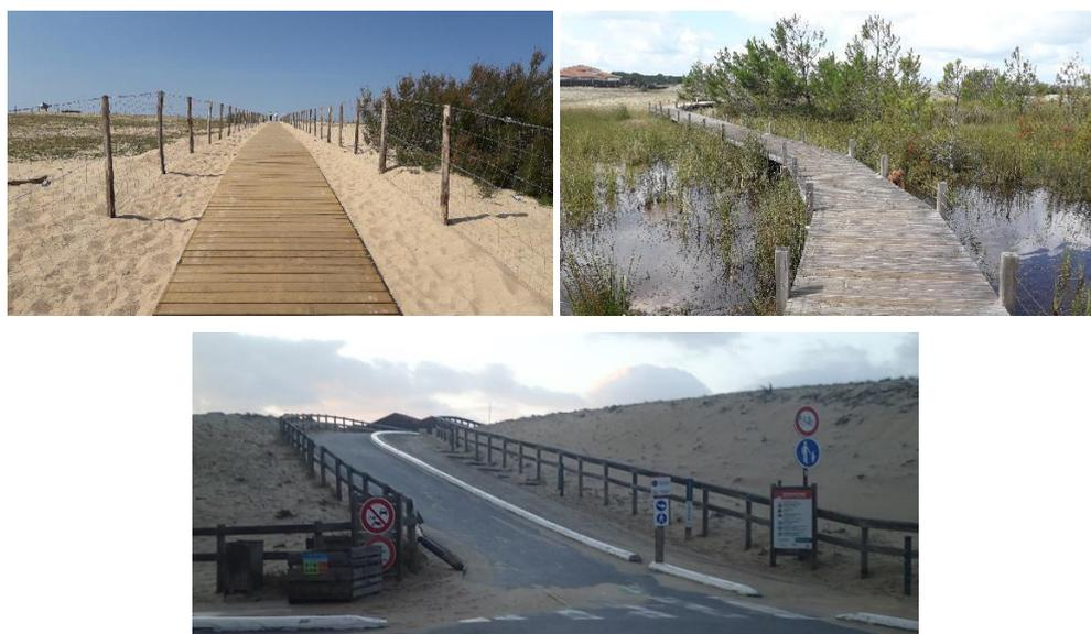
Photo 1: Revêtement de tronçons en platelage bois Tarnos en haut à gauche, à Biscarrosse à droite et revêtement bitume en bas ( J. Maia et D. Boulet, ONF)
